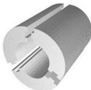
1 - скорлупы 2 - замковое соединение 3 - изолируемая поверхность
